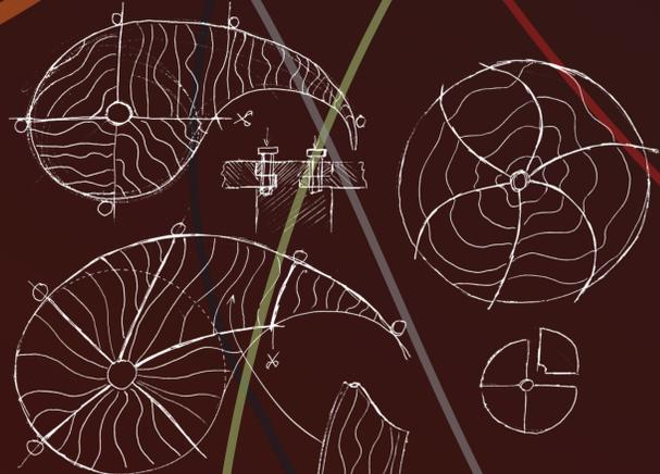
Konstruktionsoptionen der Hauptbühne (Trennung in mehrere Kuchenstücke)
