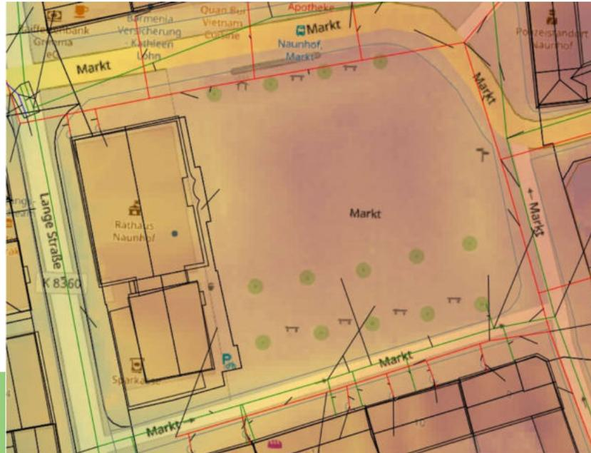
Ausschnitt digitales Geländemodell - die Entwässerungsrinne wird durch eine helle Farbgebung deutlich
